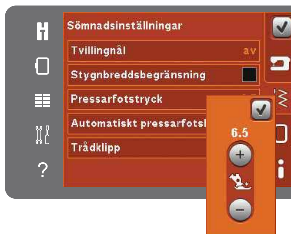
Reglage för pressarfotstryck
